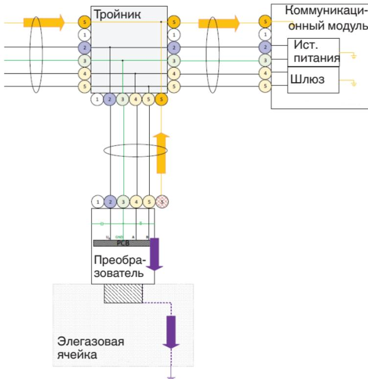
Помехи в режиме синфазного сигнала компенсируются благодаря экрану кабеля или заземлению преобразователя.
