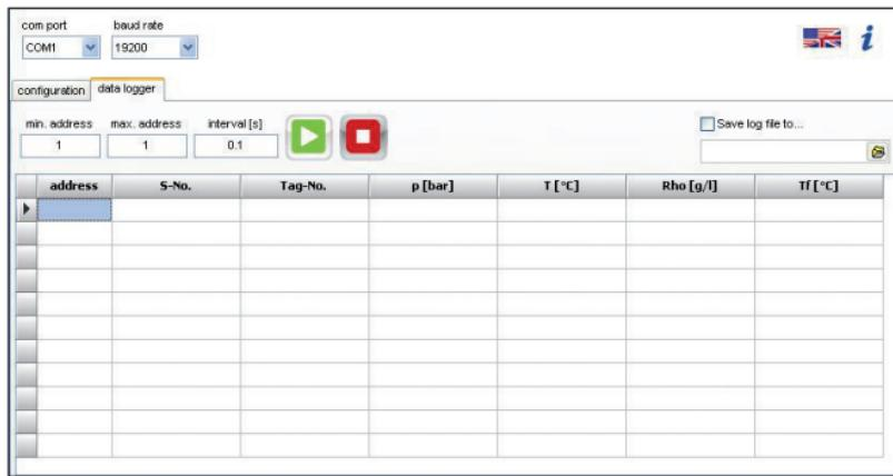
После настройки СОМ-портов, скорости передачи данных, диапазона адресов или интервала записи, может быть запущена функция регистратора. Для обеспечения непрерывности измеренных значений запись в файл может выполняться за определенные промежутки времени, с последующим преобразованием данных, разделенных знаками табуляции. Процесс записи запускается путем нажатия зеленой клавиши. Остановка записи производится нажатием красной клавиши.
