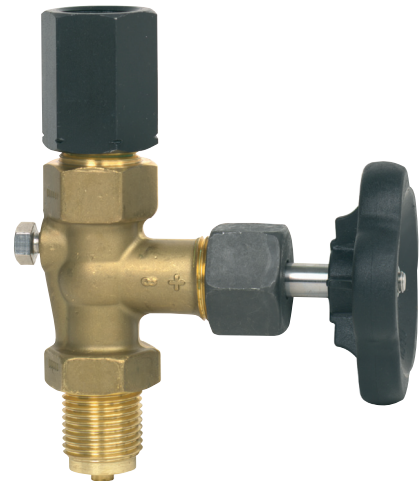
标准阀 DIN 16 270 LH-RH 调节螺母/ 外螺母 G 1/2, PN 250
